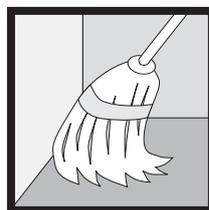
**Fig.37** - La superficie del sottofondo deve essere pulita. Polvere, oli, grassi, sporco e detriti devono essere rimossi in quanto possono compromettere l'adesione del collante.
