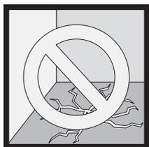
**Fig.38** - Nei massetti a base cementizia la presenza di fessure da ritiro igrometrico è causata da uno o più dei seguenti fattori: eccesso di acqua nell'impasto, aggregato di granulometria troppo fine, eccessivo quantitativo di cemento. Prima di procedere alla posa è necessario sigillare le eventuali fessurazioni.
