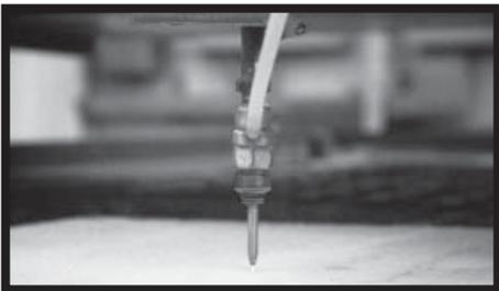
**Fig.28** - KERLITE, in tutte le sue tipologie, può essere forato anche utilizzando macchine a idrogetto. L'idrogetto permette di realizzare fori di diametro inferiore rispetto a quelli realizzabili con macchine a controllo numerico. La velocità operativa deve essere compresa tra 2 e 3 m/min.
