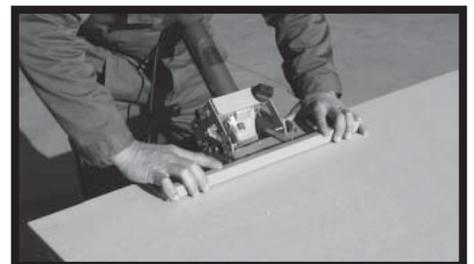
**Fig.22** - L'utilizzo di smerigliatrice abbinata a particolari carrelli permette l'esecuzione di smussi piatti con angolazioni tra 35° e 55° (con carrelli tipo Jolly-angle della **Sigma**) o di smussi rotondi (con carrelli tipo Bull di **Raimondi**).
