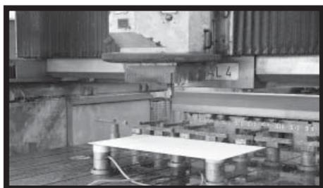
**Fig.25** - KERLITE, in tutte le sue tipologie, può essere tagliato anche utilizzando macchine a controllo numerico. La fresa per queste macchine richiede una velocità di rotazione compresa tra 12000 e 18000 rpm, con velocità di avanzamento compresa tra 0,5 e 1 m/min.
