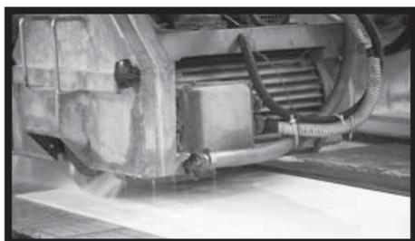
**Fig.24** - KERLITE, in tutte le sue tipologie, può essere tagliato anche utilizzando dischi diamantati. I dischi devono essere per gres porcellanato e in buone condizioni.
