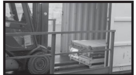
**Fig.8** - Per inforcare il pallet sul lato corto (es. nello scarico dei containers) si dovranno assolutamente utilizzare forche lunghe almeno 2,5 m per una perfetta presa e sollevamento a garanzia dell'integrità del contenuto.
