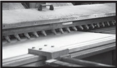
**Fig.30** - Per realizzare un taglio a 45° si possono utilizzare dei dischi diamantati inclinati a 45°. In questo modo è possibile realizzare uno spigolo con due lastre di KERLITE, in tutte le sue tipologie. Il nuovo spigolo dovrà essere poi smussato. Si possono ottenere numerose tipologie di finitura di bordo utilizzando differenti mole. La velocità operativa deve essere testata preventivamente.
