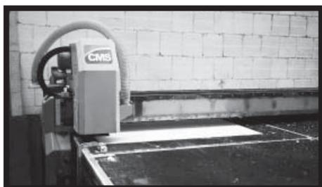
**Fig.23** - KERLITE, in tutte le sue tipologie, può essere tagliato per incisione. L'incisione è eseguita su un banco di taglio e viene fatta sul fronte della lastra. Nel caso di KERLITE 3plus e KERLITE 5plus occorre tagliare la rete di fibra di vetro a mano con un cutter se questa funzione non è possibile in maniera automatica sul tavolo da taglio.
