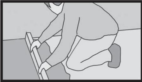
**Fig.59** - Per i massetti cementizi il periodo di stagionatura/maturazione è uno dei requisiti più importanti. Per i massetti tradizionali in sabbia e cemento questo è di circa 7/10 giorni per cm di spessore. Per massetti premiscelati, quali ad esempio Topcem Pronto della Mapei o Keracem Eco Pronto della Kerakoll, seguire le indicazioni definite dal produttore.
