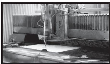
**Fig.26** - KERLITE, in tutte le sue tipologie, può essere tagliato anche utilizzando macchine a idrogetto. Raccomandiamo di utilizzare una velocità di operazione compresa tra 2 e 3 m/min.
